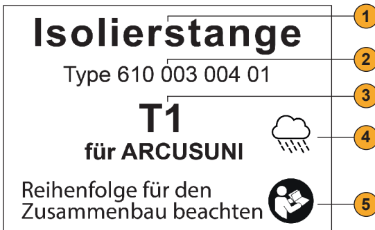
Abbildung 7: Beispiel für Etikett an der Isolierstange
