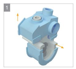
Ziehen Sie die Isolierkappe nach oben. Schieben Sie das Unterteil heraus.
