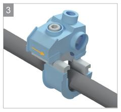
Setzen Sie das Oberteil mit hochgezogenner Isolierkappe seitlich an das Unterteil und schieben Sie beide Teile bündig zusammen.
