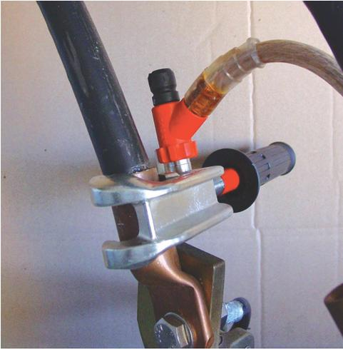
Verbinden Sie die Erdungs- und KurzschlieÙvorrichtung stets zuerst mit der Erdungsanlage bzw. dem Kabelschuh der N-/PEN-Trafoanschlussleitung.
