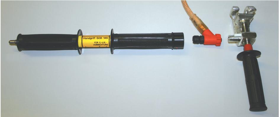
Verwenden Sie zur fachgerechten Montage unbedingt unseren Handgriff Type 508 145! Stecken Sie den Handgriff auf die Schraubkupplung der Erdungs- und KurzschlieÙvorrichtung auf, und schrauben Sie diese fest auf den dafür vorgesehenen Anschluss der Anschleißklemme (siehe [Seite 8](#)). Aufgrund der räumlichen Gegebenheiten an den Trafoanschlüssen wird empfohlen, die Anschleißklemmen vor dem Einsatz am Trafo mit der Erdungs- und KurzschlieÙvorrichtung zu verbinden.
