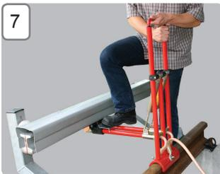
Ziehen Sie den Handgriff ein kleines Stück nach hinten, um den Formschluss an der Stromschiene aufzuheben.
