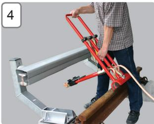
Setzen Sie den Kurzschließer wie abgebildet auf die Fahrschiene, so dass der Kontaktfuß und die Haltemagnete satt aufliegen.
