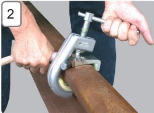
Montieren Sie als erstes die Schienenkopfklemme handfest auf einem blanken Abschnitt der von der Stromschiene weiter entfernten Fahrschiene.
